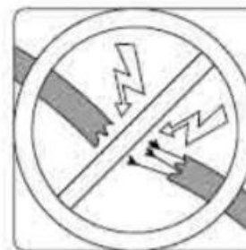
Skontrolujte či sú káble poškodené
